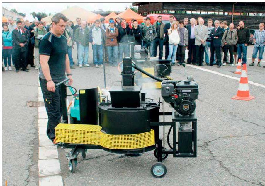
Součástí technologie TAR může být ohříváč MM 80 pro přípravu originálního materiálu Megaphalt
